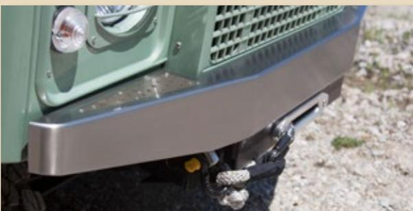
Die Abenteuer4x4-Windenstoßstange ist aus Edelstahl gefertigt, im Finish perfekt gebürstet und besonders stabil. Zusätzliche Einlagen aus eloxiertem Aluminium mit Noppen sorgen für einen rutschfesten Stand. Kaum sichtbar und gut geschützt: die WARN-Seilwinde aus der Zeon-Serie mit elektrischer Freilaufschaltung.
