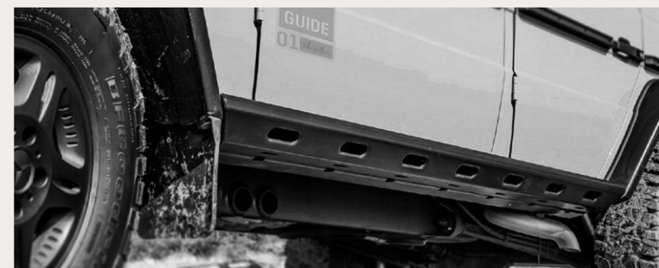
Die **ABNTR4X4-ROCKSLIDER MERCEDES „G“** bieten optimalen Fahrzeugschutz im Gelände. Der G-Slide ist passend für alle Modelle 461/463 und wird an den originalen Haltepunkten der Trittbretter verschraubt. Die eingepasste Form aus 3-mm-Edelstahl fügt sich optimal in die Silhouette des Fahrzeugs ein.
