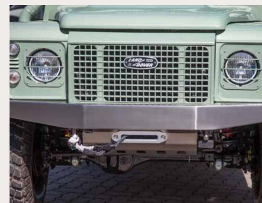
Die formschöne **ABNTR4X4-WINDENSTORSTANGE** für den Defender TD4 mit Klimaanlage glänzt durch dezente Optik und ist ideal für Reisefahrzeuge und alle Ästheten unter den Offroadern! Kaum sichtbar und durch einen Unterfahrschutz geschützt, ist die Winde hinter der Stoßstange am Rahmen montiert und dadurch vor Witterungseinflüssen perfekt geschützt.
