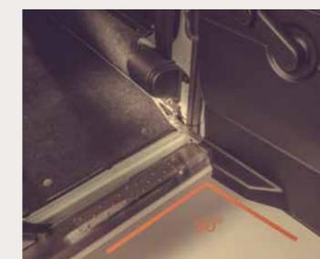
**ABNTR4X4-TÜRÖFFNUNGSWINKEL** sorgen für bequemes Ein- und Aussteigen sowie besseres Be- und Entladen von sperrigen Gegenständen. Durch die verstellbaren Türwinkel aus Edelstahl lassen sich die hinteren Türen bei allen Defendern von 80° bis 95° öffnen.
