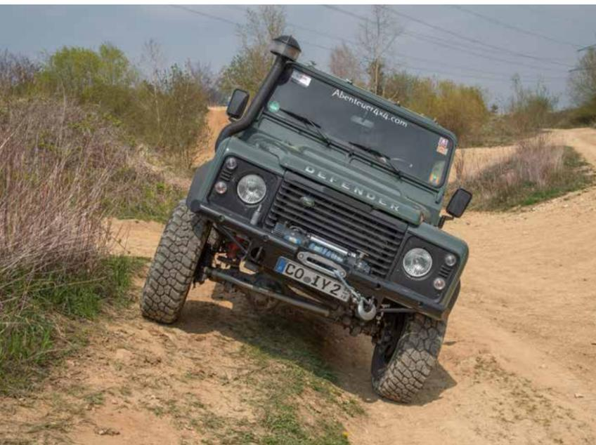
**SCHRÄGFAHRT** - Der entscheidende Faktor bei Schrägfahrten ist der Schwerpunkt des Fahrzeugs. Je höher er liegt, umso schneller kippt das Fahrzeug zur Seite. Faktoren, die den Schwerpunkt nach oben verlagern können, sind Dachträger, Gepäck auf dem Dachträger oder auch Fahrzeug-Höherlegungen. Spurverbreiterungen können den Schwerpunkt in gewissen Grenzen wieder etwas positiv beeinflussen. Zuviel Bedeutung sollte man dem aber nicht beimessen.
