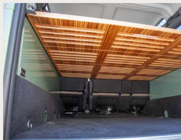
Der **ABNTR4X4-MULTIFUNKTIONS-UND-SCHLAFAUSBAU** für den 110 TD4 bietet mit minimalem Aufwand maximalen Komfort. Zu Stauraum durch eine zweite Ladeebene oder eine 180 cm lange Liege bei umgelegter Rückbank machen den Landy zum Camper. Außerdem verschiedene Matratzensysteme an.
