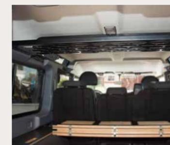
Das **ABNTR4X4-DACHSTAU-FACH** schafft zusätzlichen Stauraum unter dem Defender-Dachhimmel. Montiert wird das leichte Bauteil an der originalen Innenverkleidung zwischen den Oberlichtern und der Hecktür. Es ist zum Verstauen leichter Gegenstände geeignet.
